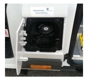
**DIESEL FILLER CAP. Near side.**
