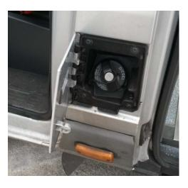
**DIESEL FILLER CAP. Near side.**
